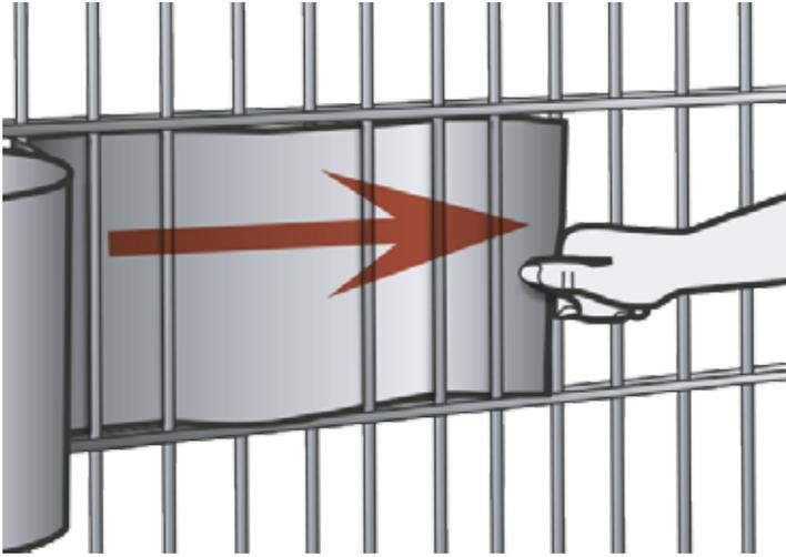
Sichtschutzstreifen werden in die Maschen des Gittermattenzauns eingeflochten. Die Streifen von 19 cm Höhe passen üblicherweise in die Gittermattenzäune mit einem Stababstand von ca. 20 cm.
