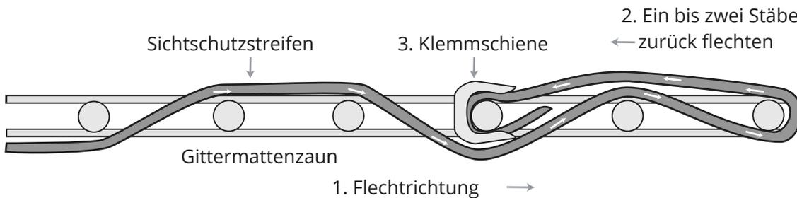
Am Ende der Gitterreihe wird der Sichtschutzstreifen ein Stück zurückgeflochten. Dadurch können Temperatur-Spannungen ausgeglichen werden.
