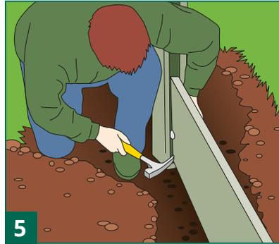
Andrücken der Platte mit der Motivseite und Verkeilen der entstandenen Fuge mit einem Stein. Bei Montage von 2 Motivplatten Platzieren von zwei Platten gegeneinander und Verkeilen dazwischen.
