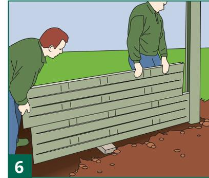
Passgenaues Einsetzen der Betonplatten bis zur Oberkante in Waage und Verkeilen der einzelnen Platten.
