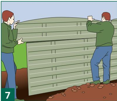
Zur Unterstützung des Fundamentes sollten die Betonplatten aufliegen. Dies gilt besonders bei Montage von doppelseitigen Motivplatten.
