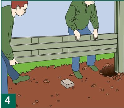
Setzen der ersten Betonplatte durch Einführen in die Nut. Lagerung der Platte auf einem Pflasterstein. Auf waagerechte Ausrichtung der Platte achten.
